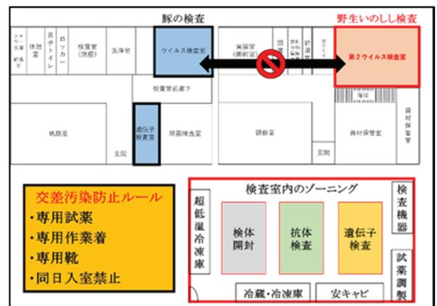
図1 野生いのしし専用検査室の整備と交差汚染防止対策
