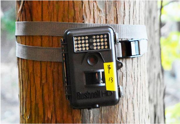
図16 赤外線センサーと赤外線照射機能をもつカメラを立木に設置。カメラは動物を感知すると30秒間動画撮影をする。ネズミー匹にも反応する。
