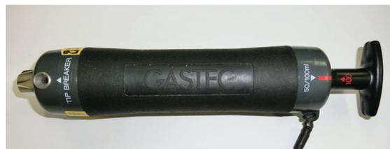
図2 検知管式気体測定器 (GV-100S)
