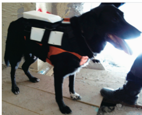
図4 大型犬用の行動計測スーツ（3号機）を装着した日本救助犬協会の災害救助犬
