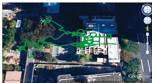
図7 搭載センサで計測した探査軌跡：GPSデータをGoogle Mapの機能を利用して、解体される前の建物が写っている衛星写真の上に描画
